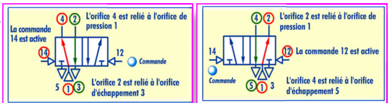
Fig III. 23: Repérage des orifices d'un distributeur.
