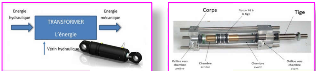
Fig II. 19 : Fonction d'un vérin hydraulique..
