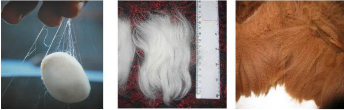
Figure I.1. Illustrations de quelques fibres animales, de gauche à droite: cocon de soie, fibres d'Angora et fibres d'Alpaga.
