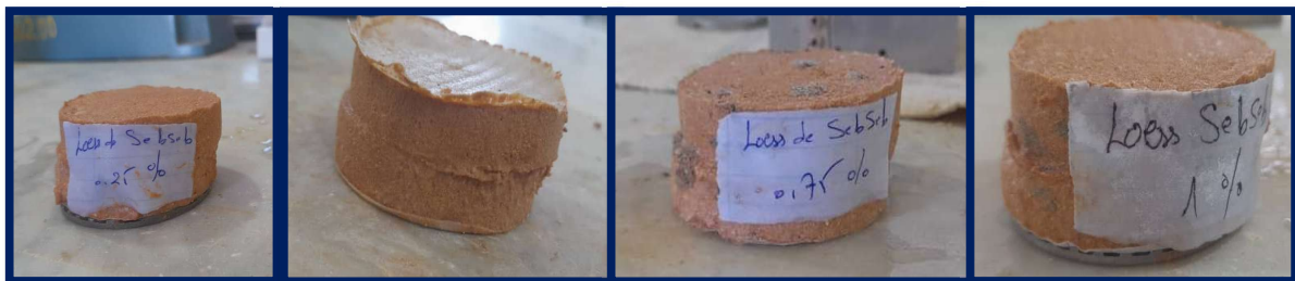
Figure 2.13 : éprouvette de sol sebseb avec fibre.
