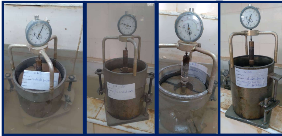
Figure 2.15 : CBR imbibé de lœss sebseb avec des fibres.
