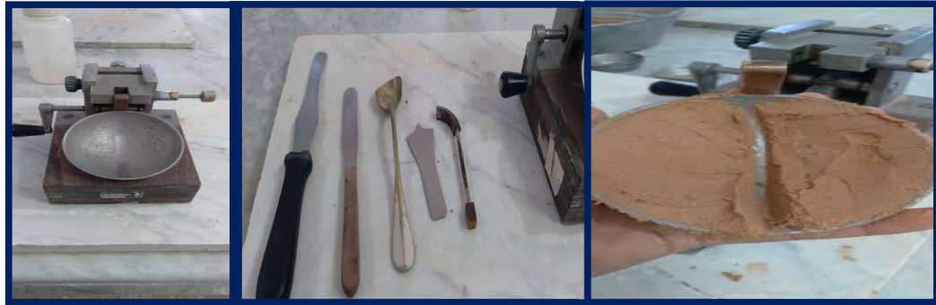
Figure 2.5 : Etude de la plasticité des sols (Limites d'Atterberg).
