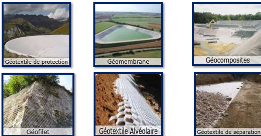
Figure 1.18 : les types de géosynthétique.
