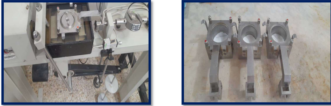
Figure 2.12 : appareillage de l'essai (boite de cisaillement).
