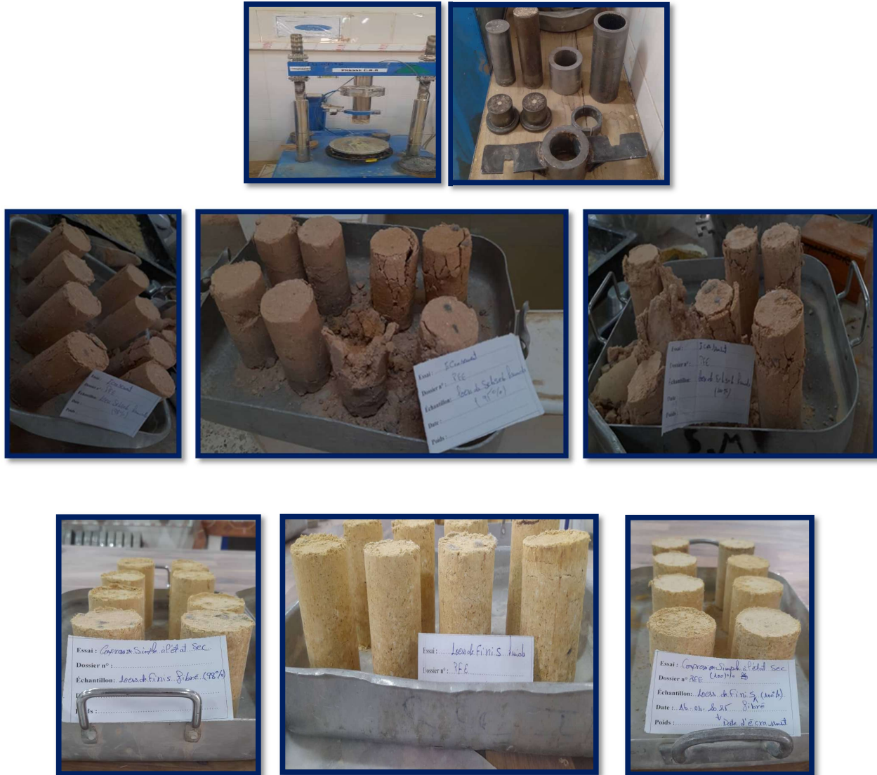
Figure 2.17: Essais de compression uniaxiale, presse et aspect des éprouvettes
