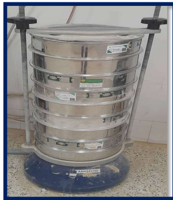
Figure 2.3 : Série de tamis et tamiseuse électrique.
