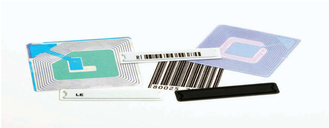
الشكل (1-10) يمثل شريحة كاشف ترددات الراديو RFID
