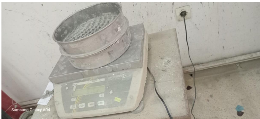
Fig V. 3 Essai de la stabilité au tamis
