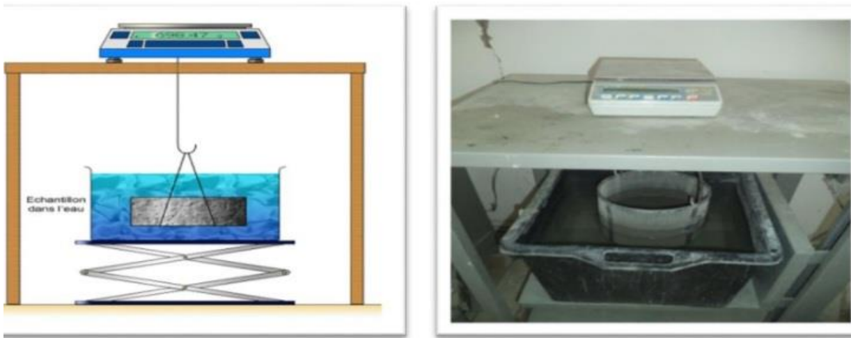
Fig V.6 : Essai de porosité à l'eau.
