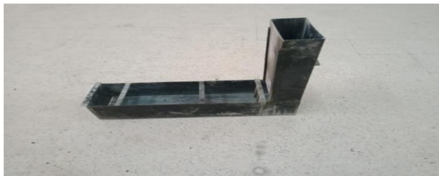
Fig V. 2 Essai de la boîte L
