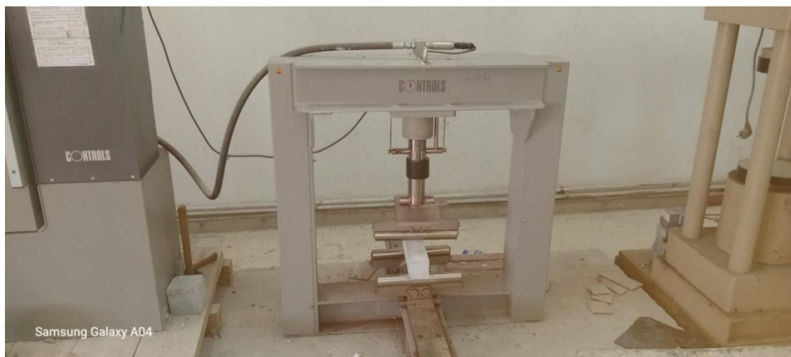
Fig .V.4 Essai de Flexion
