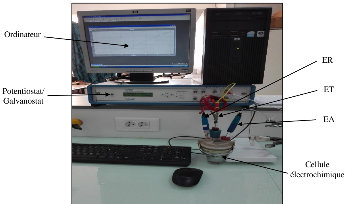
Figure II.2. Schéma du montage utilisé pour l'analyse électrochimique à la température ambiante.
