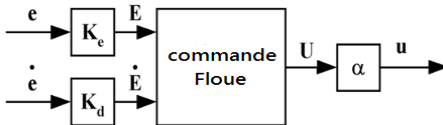
Figure II.11 : Structure de contrôleur de type PD floue.
