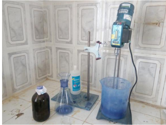
Figure 2.9. Appareillage de l'essai de bleu
