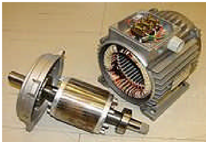
Fig. 1.1 Les constituants d'une machine asynchrone
