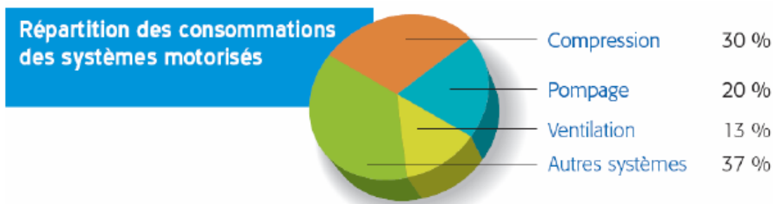
Fig. 4.3 Répartition des consommations des systèmes motorisés
