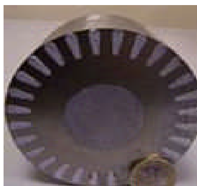
Fig. 1.5 Coupe de rotor à encoche profonde
