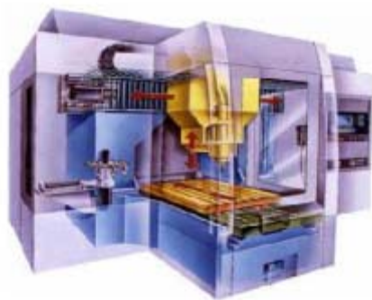
Figure I.11. Machine outil à structure sérielle de type portique [2].
