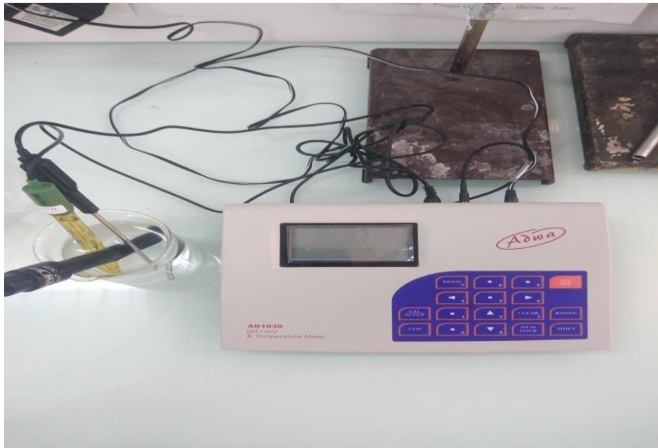
Figure 18. pH-mètre ADWA (pH AD1030).
