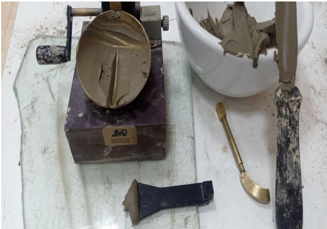
Figure 19. Dispositif d'essai de limite de liquidité (appareil de Casagrande).
