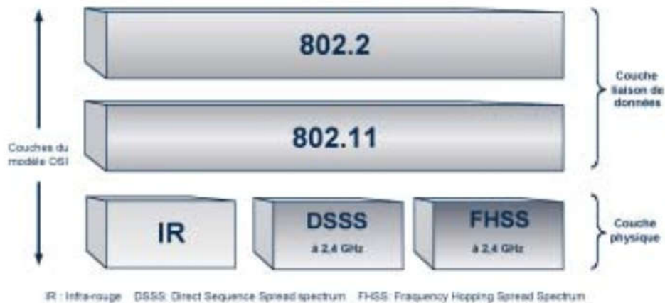
Figure I.6 : Structure du standard originel 802.11.
