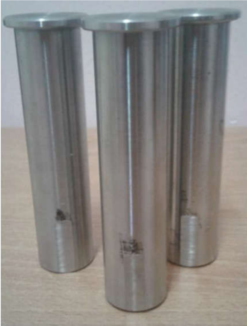
Fig.III.16 : Les éprouvettes de l'essai de Jominy
