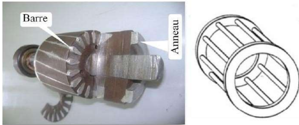
(a) Coupe d'un rotor à cage d'écureuil en aluminium [6] (b) Cage d'écureuil [8]
