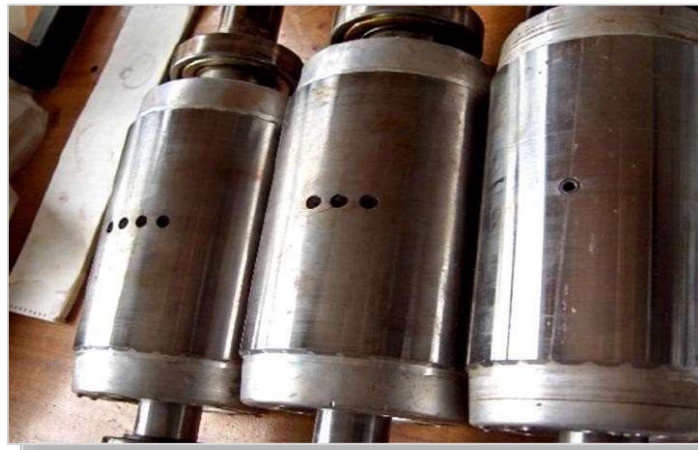
Figure I.7. Défaut de rupture de barres et d'anneau de court-circuit
