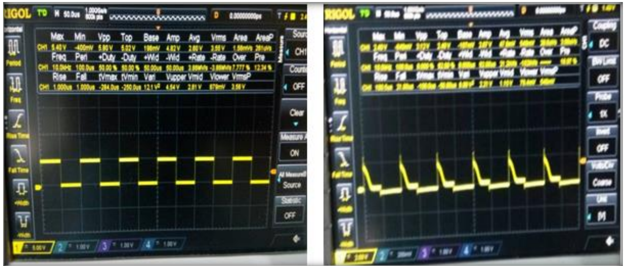
(a) L'entrée du transformateur d'impulsions. (b) La sortie du transformateur d'impulsions.
