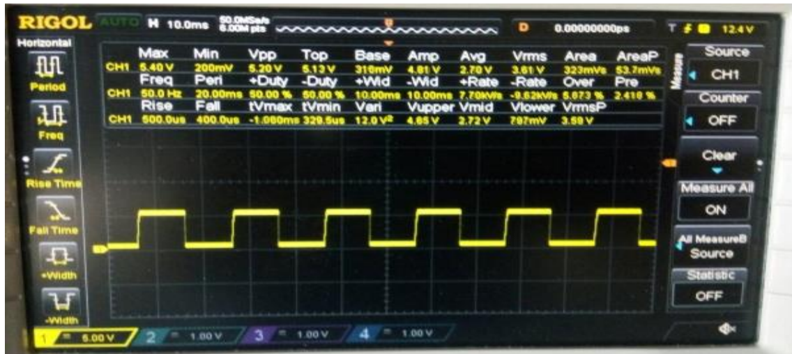
Figure III.9 Signal de la sortie de l'opto-coupleur .
