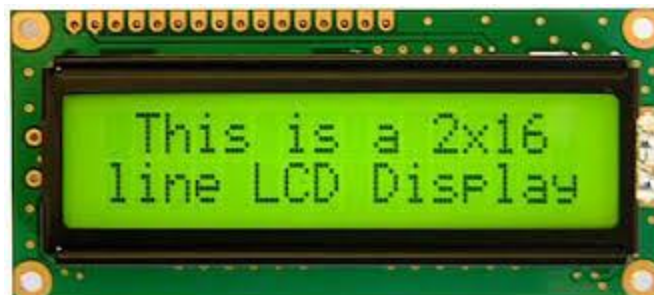
Figure III.10 Afficheur LCD avec 2 lignes de 16 caractères.
