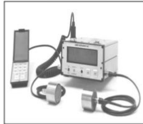
Figure I. 1 appareil à ultrason de l'auscultation dynamique [24] Figure I. 2 diagramme schématique du circuit [24]
