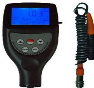
Figure III-3: dispositif utilisée pour mesurer la couche.
