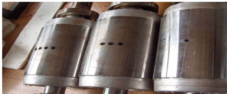
Fig. I.8. Ruptures de barres [9].
