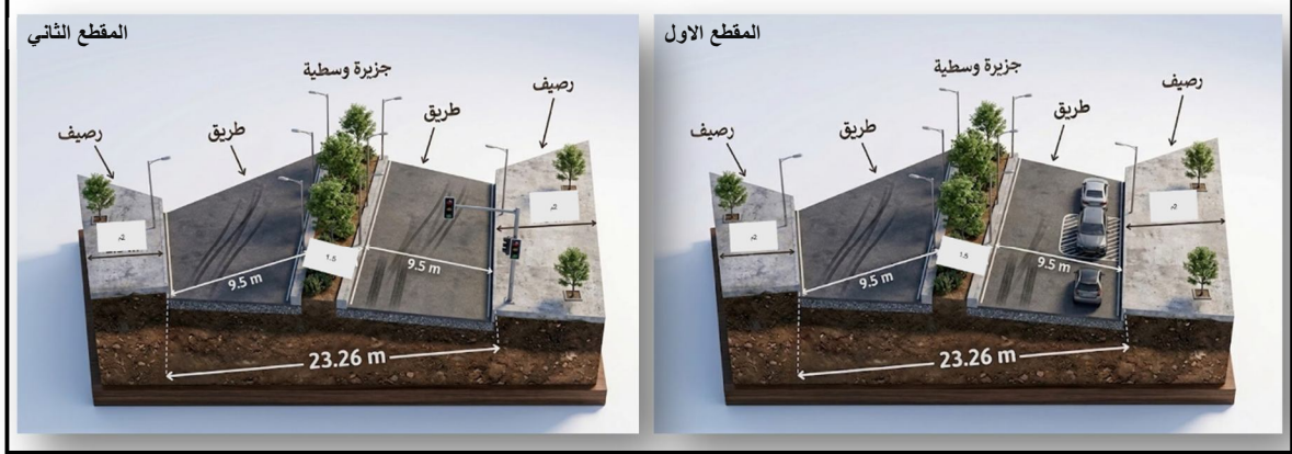
صور رقم 27-28: مقطع عرضي لمكونات الطريق
