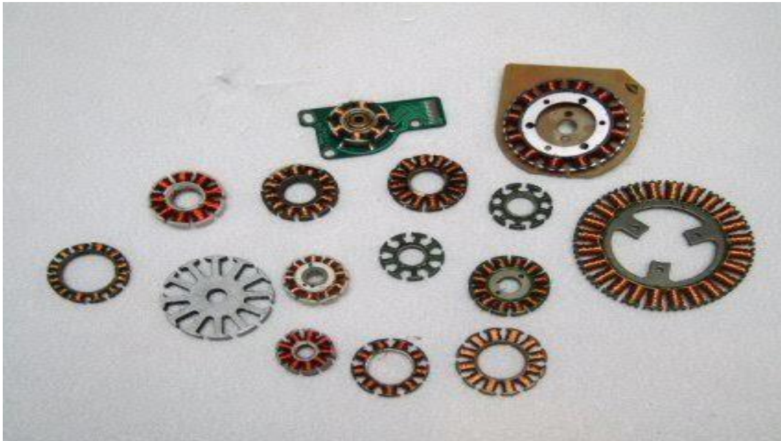
Figure I.8 : Bobinages de différents moteurs
