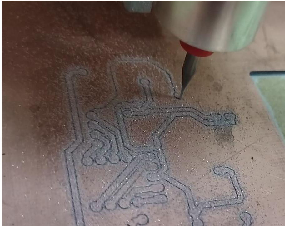
Figure III.12. La machine CNC pendant le processus de routage.
