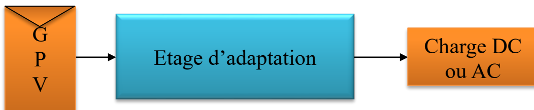
Figure II.3– Connexion GPV-charge à travers un étage d'adaptation.
