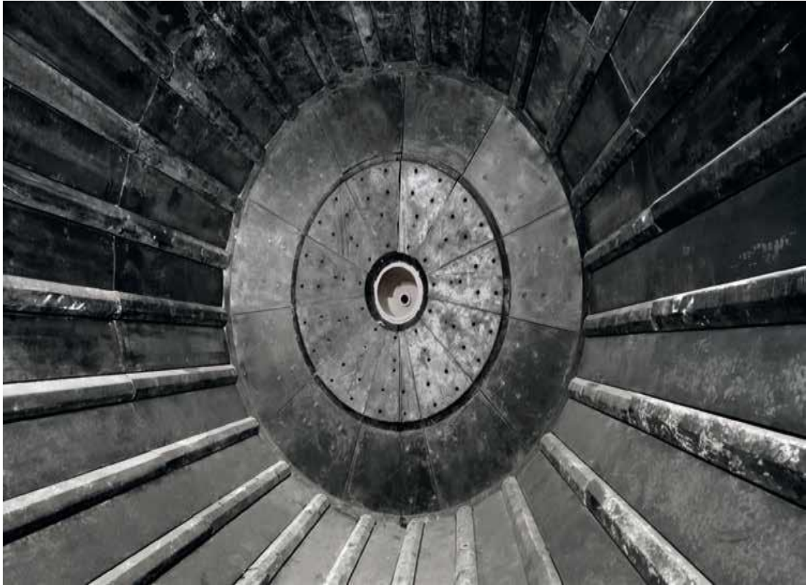
Figure IV.5 : Broyeur à boulet avec revêtement en caoutchouc [25].
