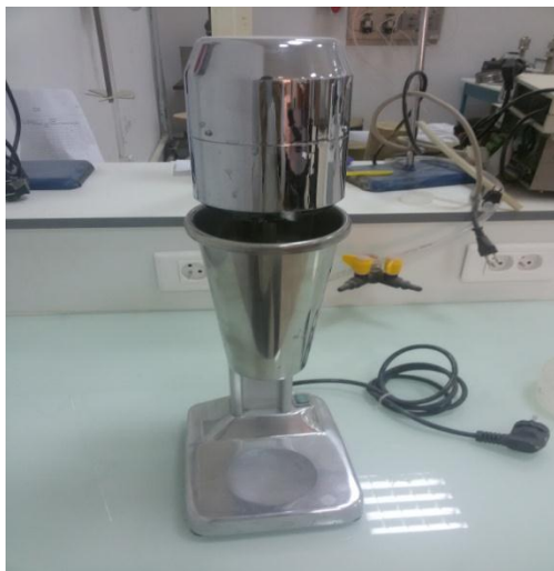
Figure II.3 : Appareillage d'analyse granulométrique sédimentométrie.
