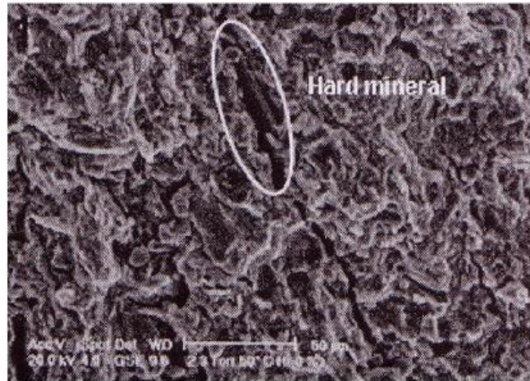
Figure I.9 : Ouverture des fissures en proximité des matériaux rigides
