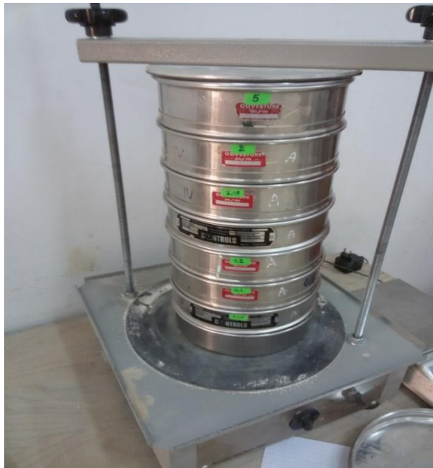
Figure II.2 : Appareillage d'analyse granulométrique (tamisage).
