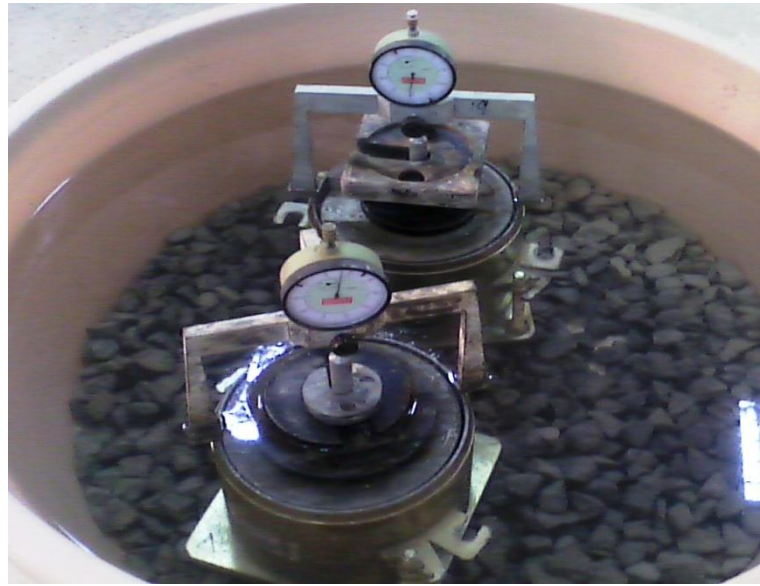
Figure II.10 : Imbibition des échantillons (essai CBR).
