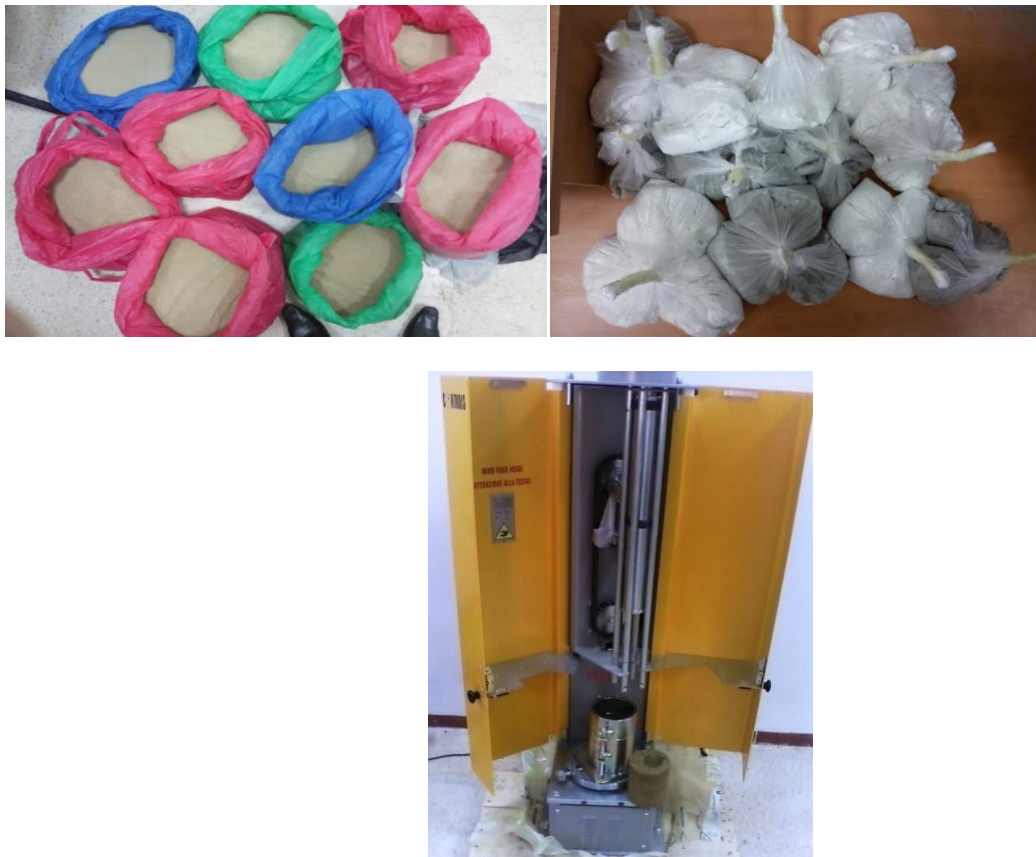
Figure II.8 : Appareil essai Proctor (compacteur automatique et les échantillons).
