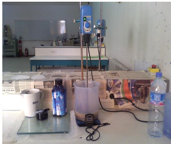
Figure II.6 : appareillage de l'essai au bleu de méthylène.
