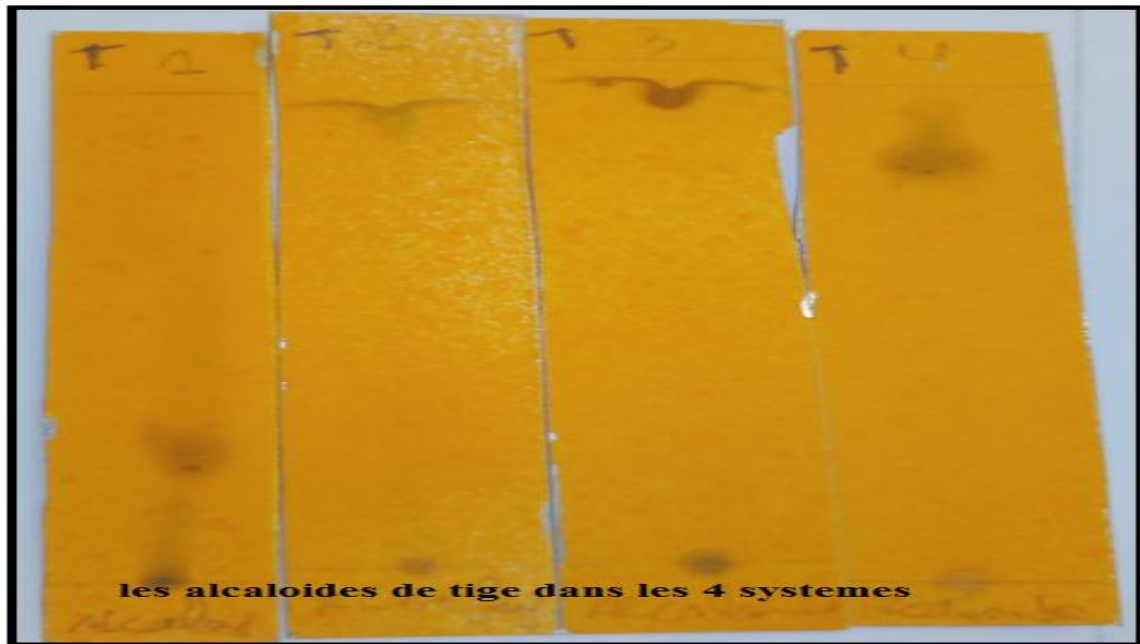
Figure 39 : Révélation de plaque CCM de gel de silice de alcaloïde de tige de la plante Salvia officinalis sous lampeUV365 nm de S1, S2, S3, S4.
