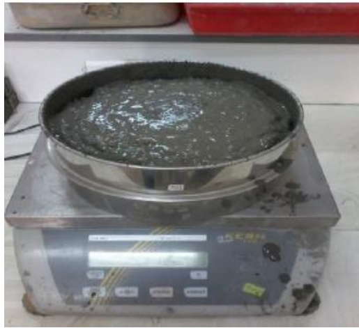
Figure V-5 : Essai Stabilité au tamis exécutés au laboratoire.
