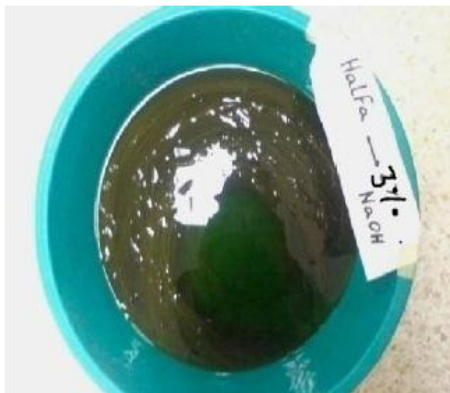
Figure IV- 10: Traitement de fibre Alfa par 3% NAOH
