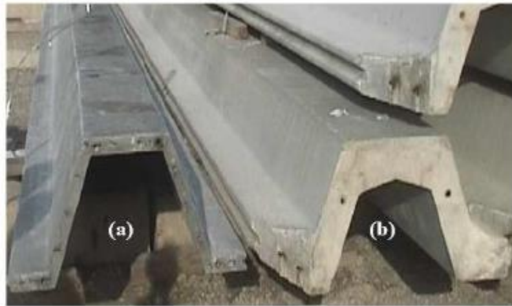
Figure II-16: Palplanches précontraintes à base de mortier autoplçant fibré (a), béton armé ordinaire (b) [17]
