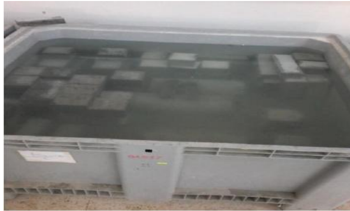
Figure V-13 : Conservation des éprouvettes.
