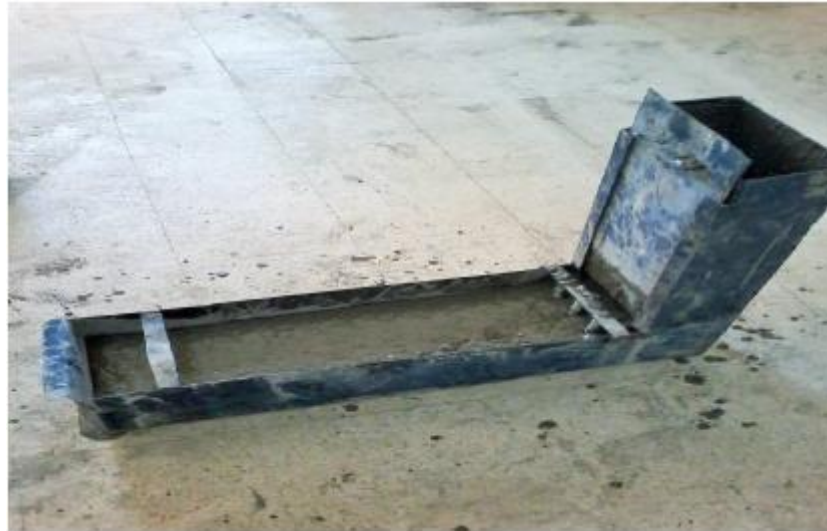
Figure V-7 : Essai de Boîte en L exécutés au laboratoire.
