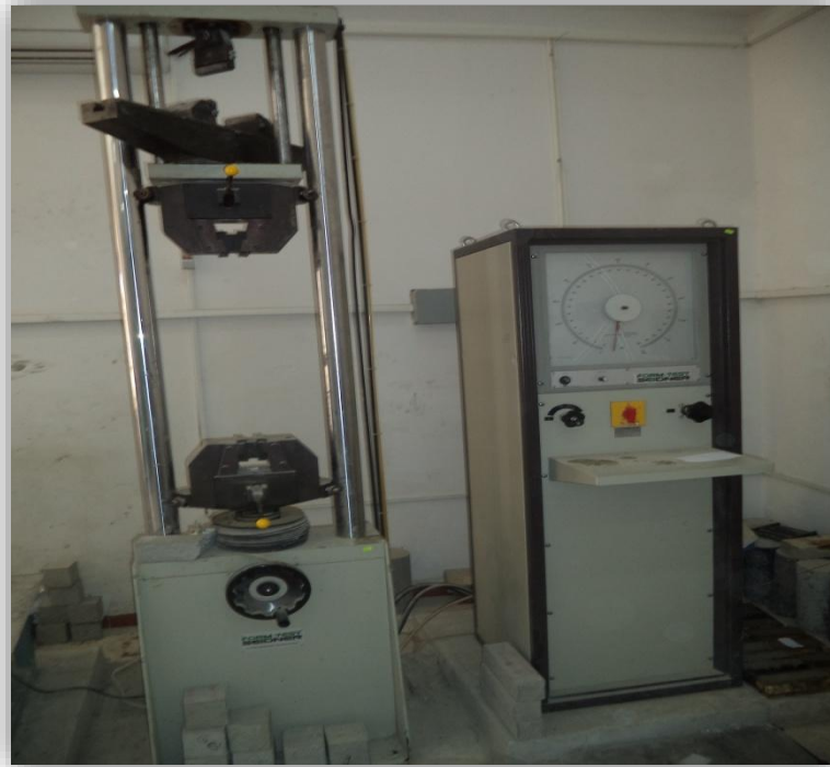
Figure I- 16: Mesure de la résistance à la traction par flexion
