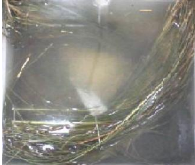
Figure IV 9: Préparation des fibres Alfa: immersion des tiges dans l'eau
