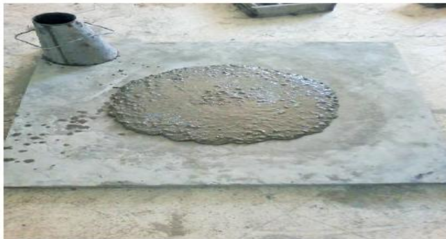
Figure V-3 : Essai d'étalement au cône exécuté au laboratoire.
