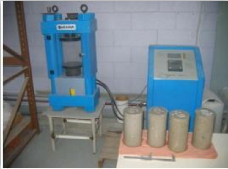
Figure I-15: Mesure de la résistance à la compression
