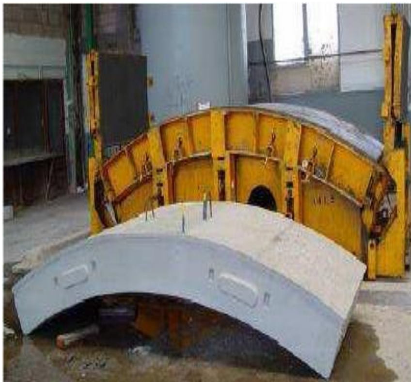
Figure II-17: Un voussoir à base de BAP fibré [17]
