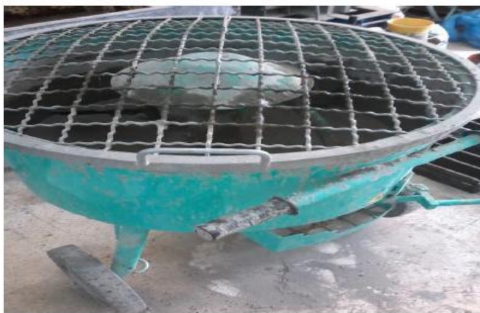
Figure V-1 : Malaxeur à béton au laboratoire des (MDC).
