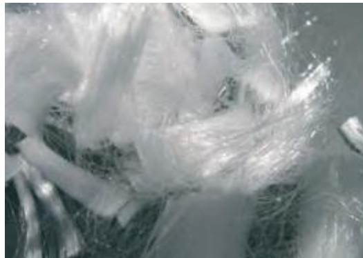
Figure II-10: Exemple de fibres macro-synthétiques utilisées en protection contre les incendies [23]
