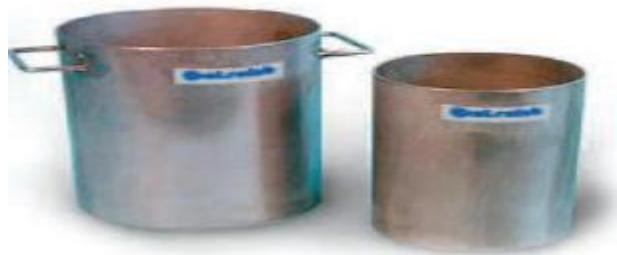
Figure IV-5: Récipient de mesure en acier pour masse volumique (10L et 7L)
