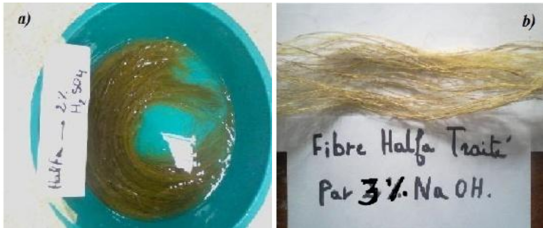
Figure IV- 11:(a) Traitement d'Alfa par H_2SO_4 éliminé les trace de NaOH, (b) Fibre d'Alfa Traitées
