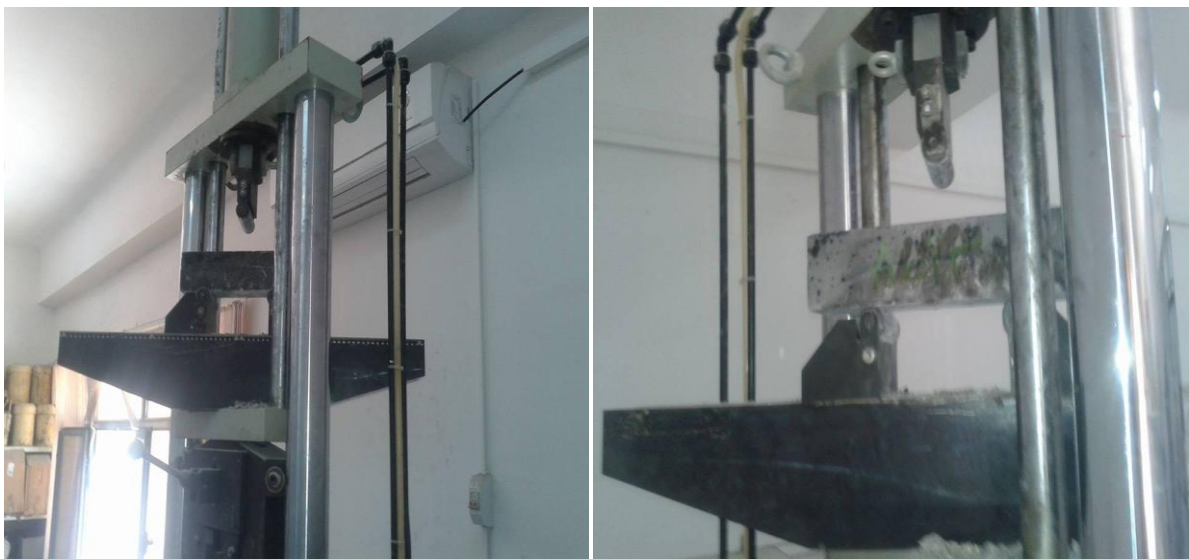
Figure V-11 : Essai de traction par flexion
