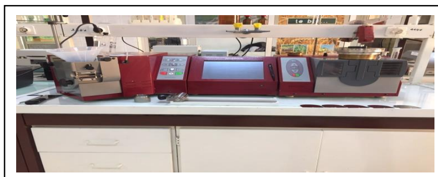
Figure 11: L'appareil Alvéographe Chopin.
