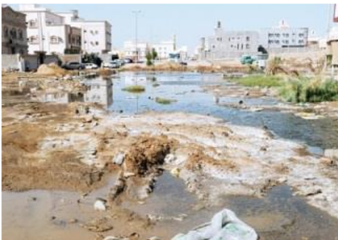
صورة رقم 10: طفوحات المياه الجوفية
