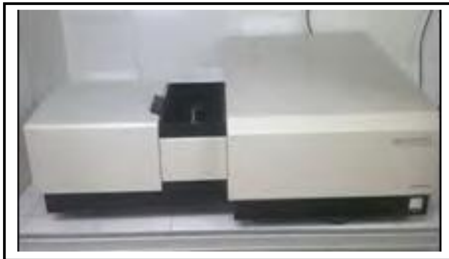
Figure II.16 : Présentation de spectroscopie UV-visible de type SHIMADZU UV-3101 PC.
