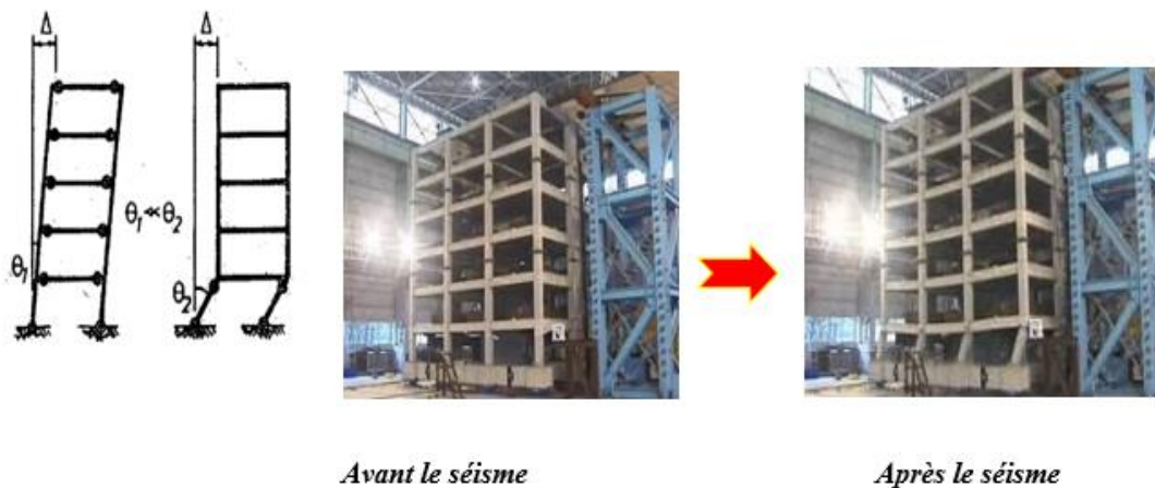
Figure1.6. Le comportement de l'étage souple.
