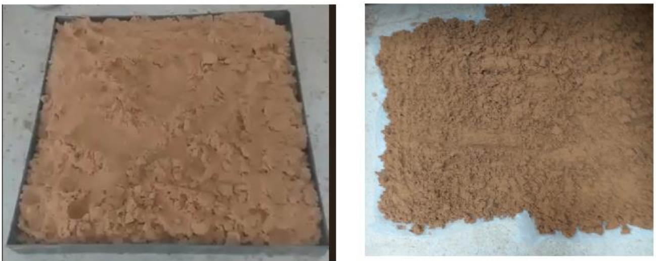
Figure IV-6 Lavage et Séchage du sable
