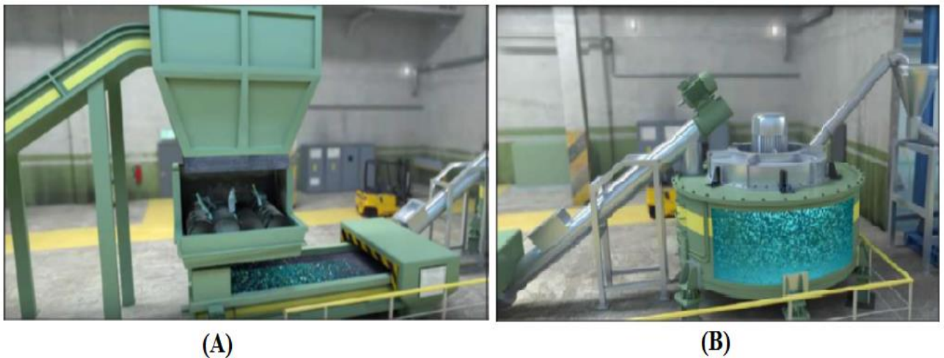
Figure I- 8 (A) Broyage plastique (B) lavage des déchets plastiques
