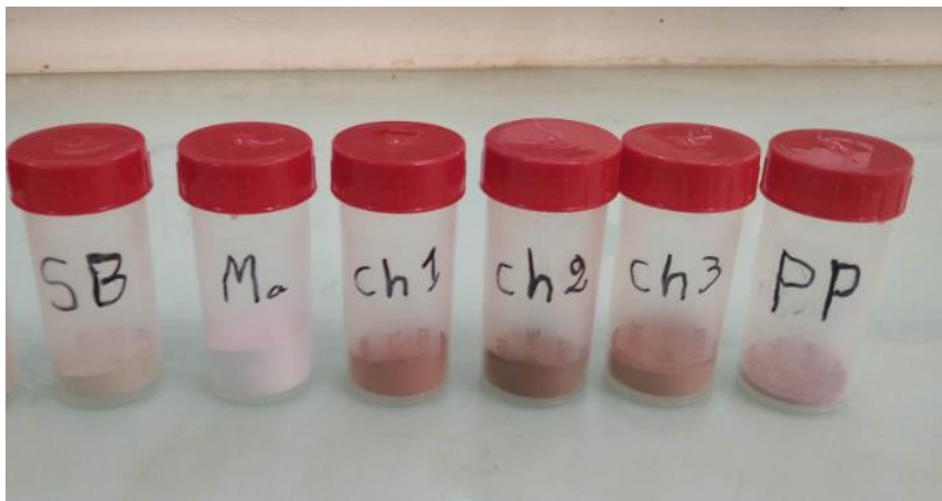
Figure IV- 12 Poudre des échantillons pour caractérisation rayons X et FTIR
