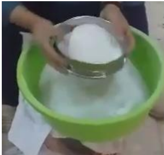
Figure IV- 10 Tamisage de chamotte à 80\ \mu\text{m} .
