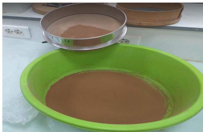
Figure IV-8 Tamisage de chamotte à 80 \mu\text{m} .
