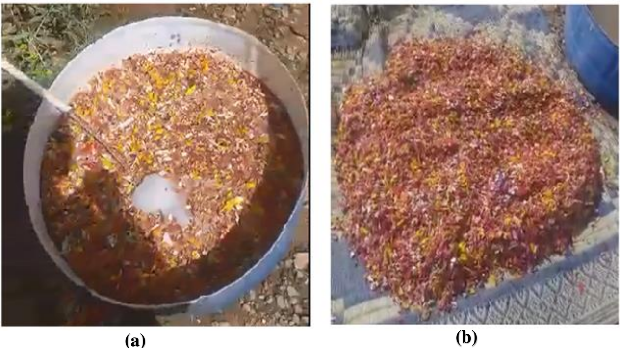
Figure IV- 4 Procédure d nettoyage et séchage de déchets plastique (a) Nettoyage (b) séchage
