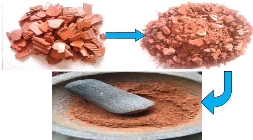
Figure III- 3 Broyage de déchets de brique.[47]
