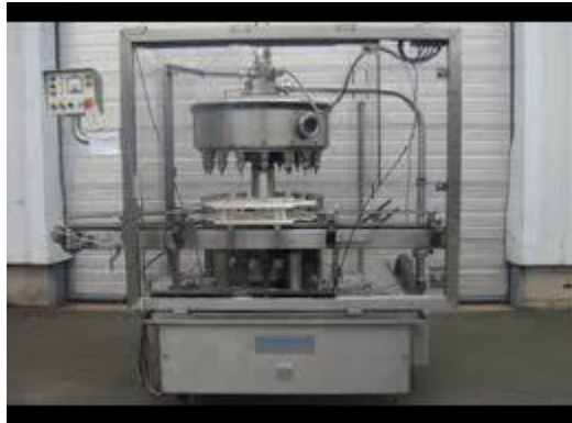
Figure II.1: Vue générale d'une remplisseuse rotative.
