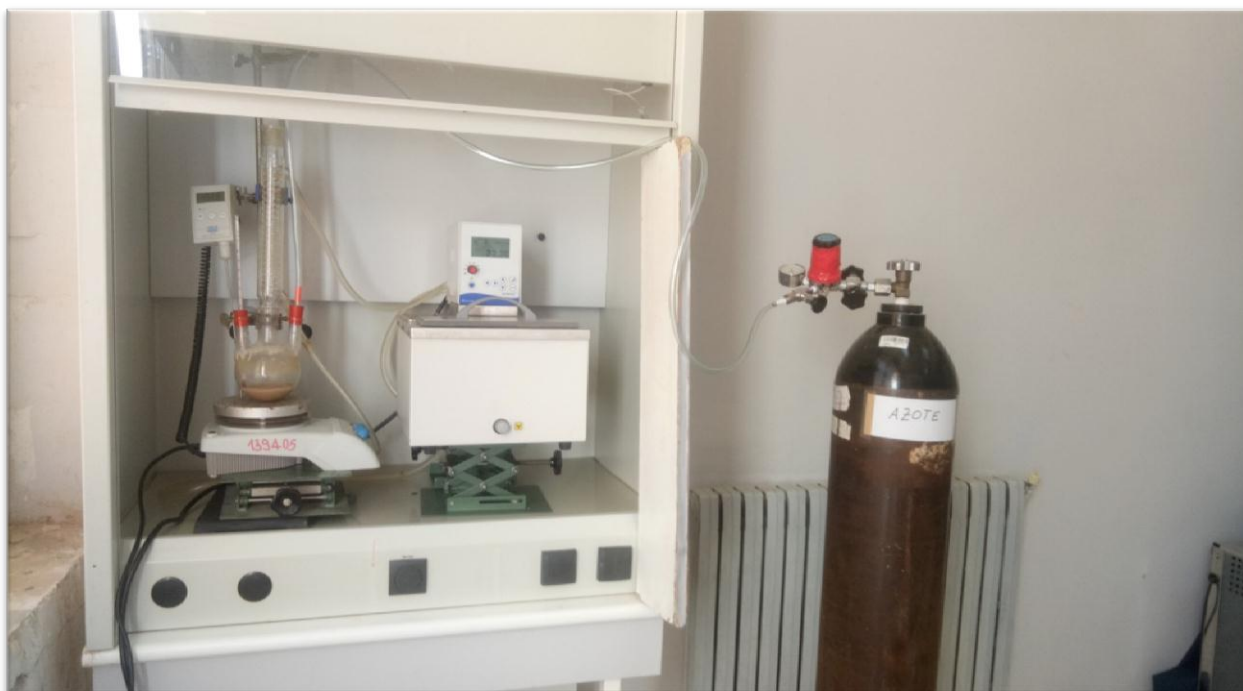
Figure.II.4 : Montage de la manipulation de greffage du MPS sur la Mte-Na.
