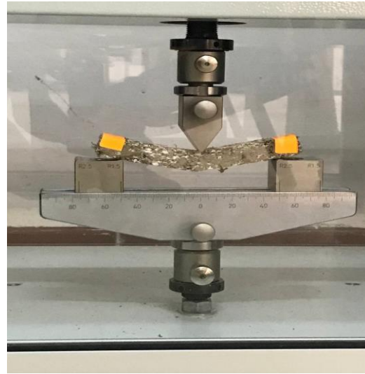
b) : Montage de flexion 3 points.
