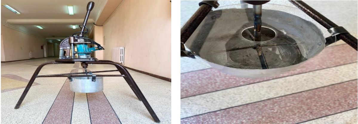
Figure IV.05 Malaxeur de mélange.
