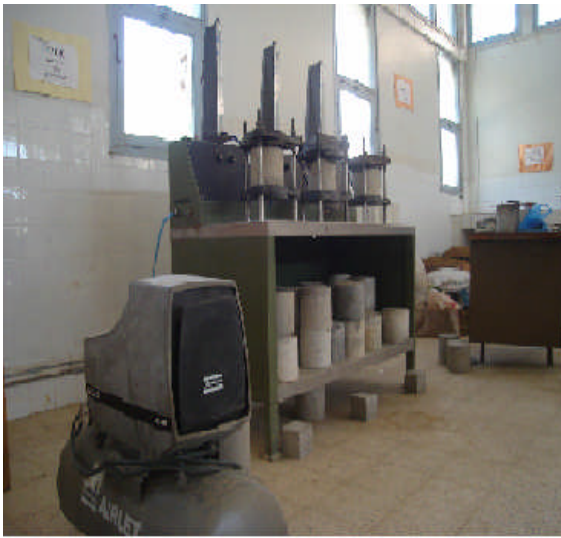
Figure IV.10 : Perméamètre à l'eau (Laboratoire de développement des géomatériaux)
