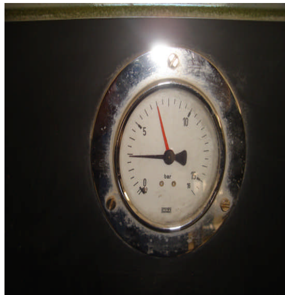
Figure II.9 régulateur de pression jusqu'à 16 bars
