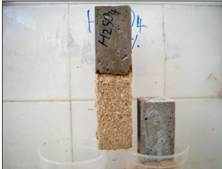
Figure IV.36: Mortier conservé dans une solution de 10% de \text{H}_2\text{SO}_4
