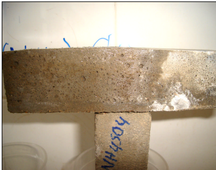
Figure IV.37 : Mortier conservé dans une solution de 10% de (\text{NH}_4)_2\text{SO}_4
