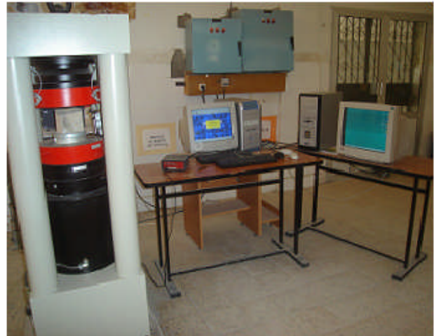
Figure IV.2 : Dispositif d'essai de compression et du module d'élasticité – laboratoire de géomatériaux de MSILA -
