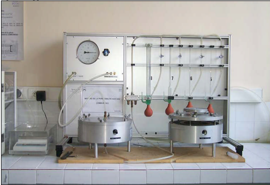
Figure II.16 : Une vue d'ensemble du perméamètre Cembureau
