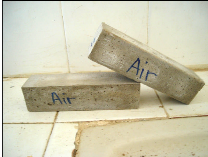
Figure IV.38 : Mortier conservé à l'air
