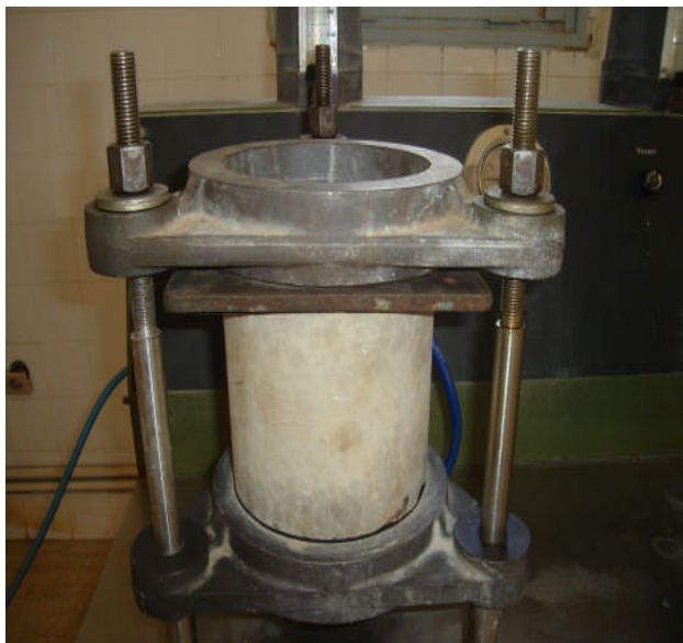
Figure II.8 : principe de fixation des éprouvettes dans l'appareil de perméabilité
