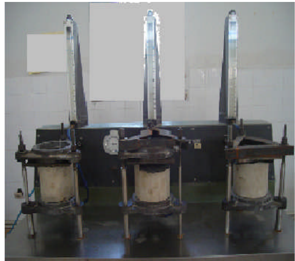
Figure IV.10 : Perméamètre à l'eau (Laboratoire de développement des géomatériaux)
