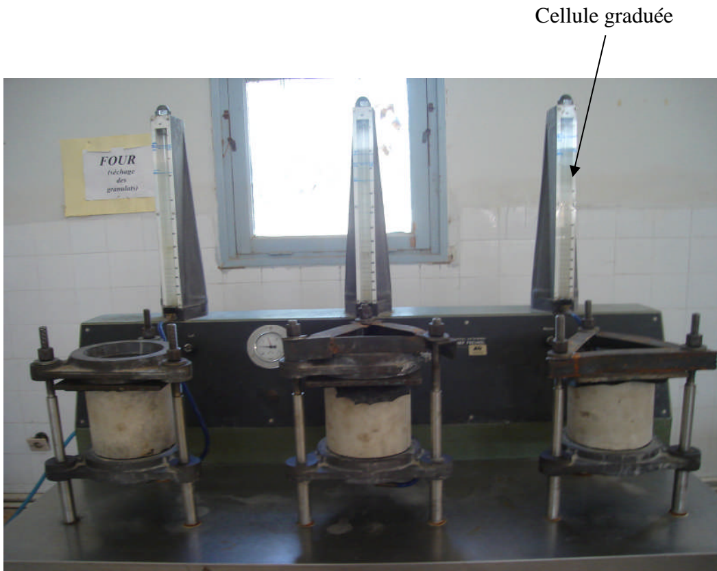
Figure II.7 : principe de fonctionnement de l'appareil de mesure de La perméabilité à l'eau du laboratoire géomatériaux de M'sila [9]
