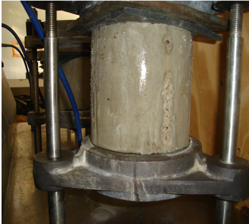
Figure IV.17 : Photos présentant la sortie de l'eau latéralement de l'éprouvette sous l'effet de l'eau en pression
