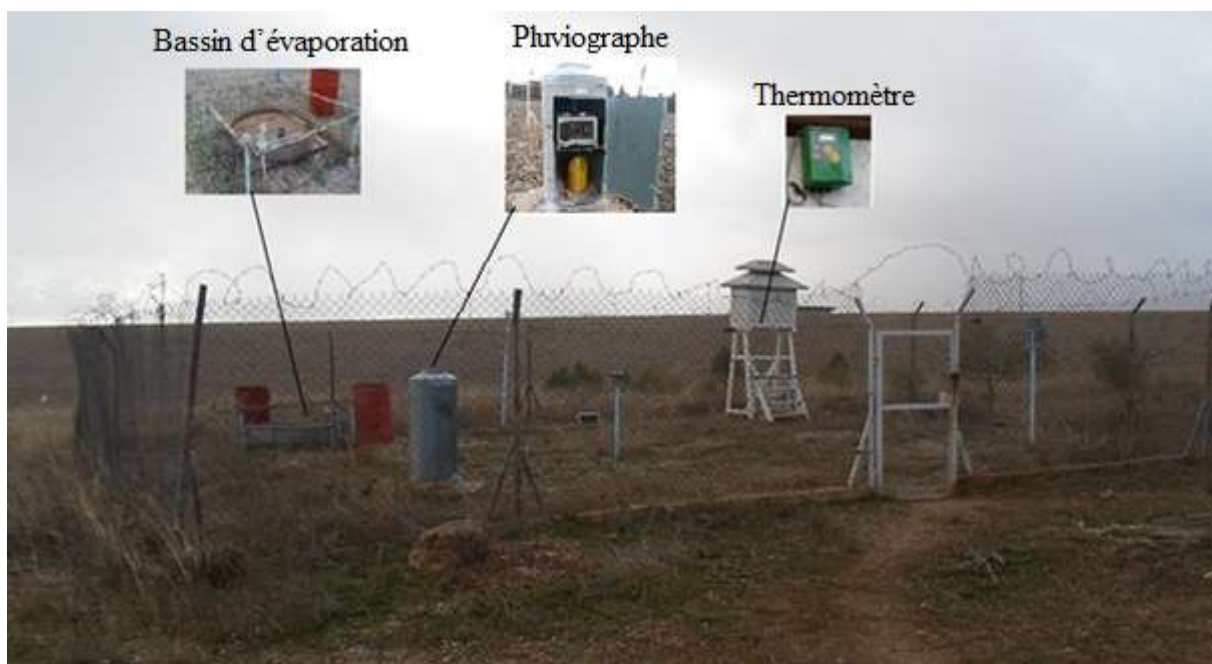
Figure III.7 Station climatique au barrage Ain Zada (Source ANBT)
