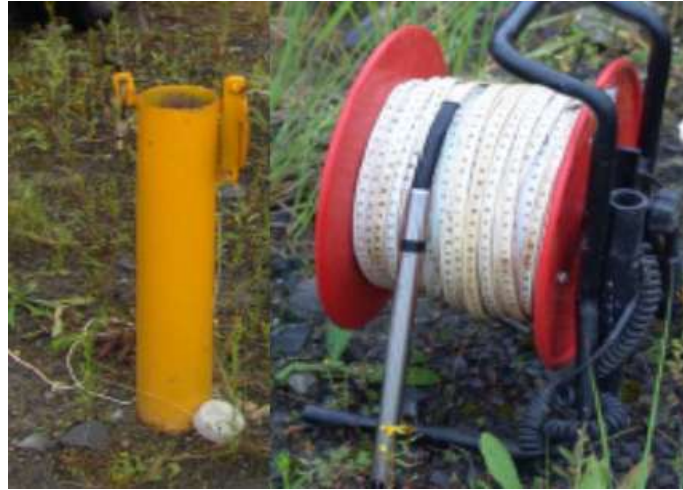
Figure III.2 Piézomètre ouvert et sonde à interface (Source ANBT)
