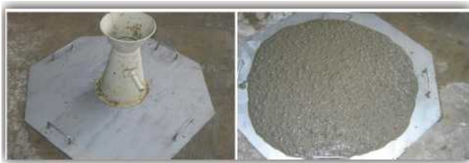
Figure I. 7-Essai d'étalement au cône d'Abrams (slump flow)
