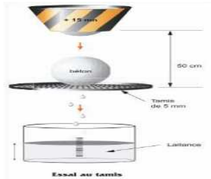
Figure III 3- Essai au tamis.
