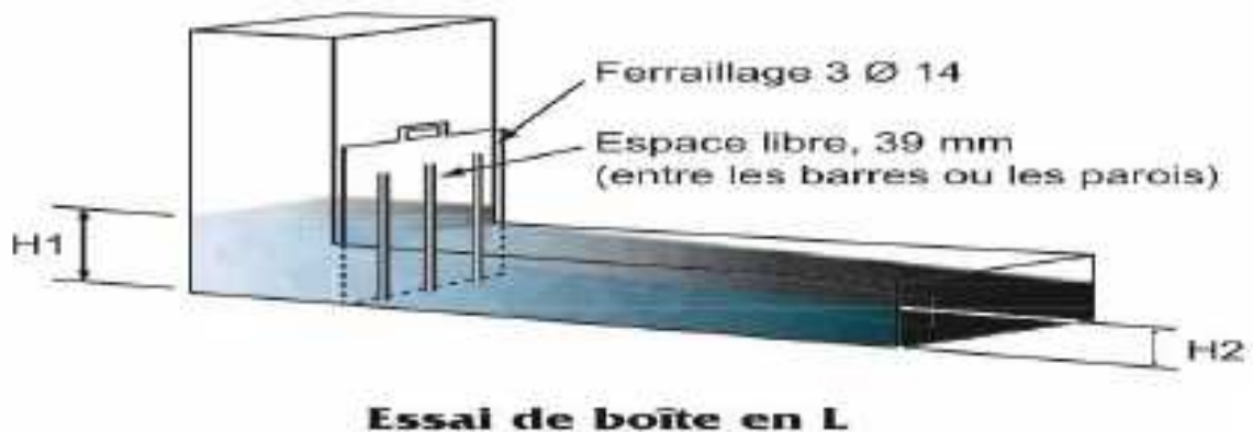
Figure III 5- Essai de boit L.
