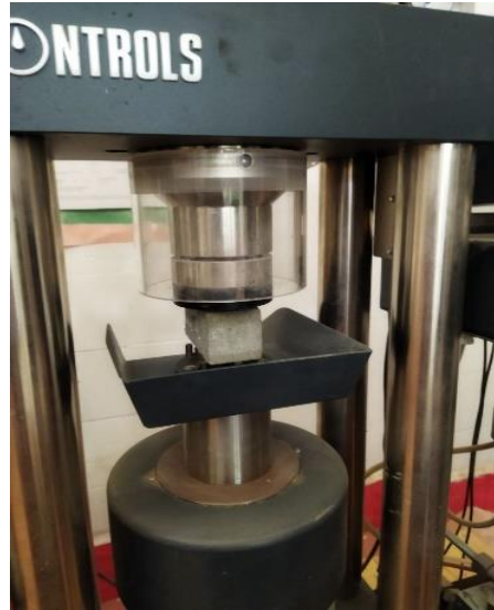
Figure II.23 : Essai de compression simple sur 4 \times 4 \times 4 \text{ cm}^3
