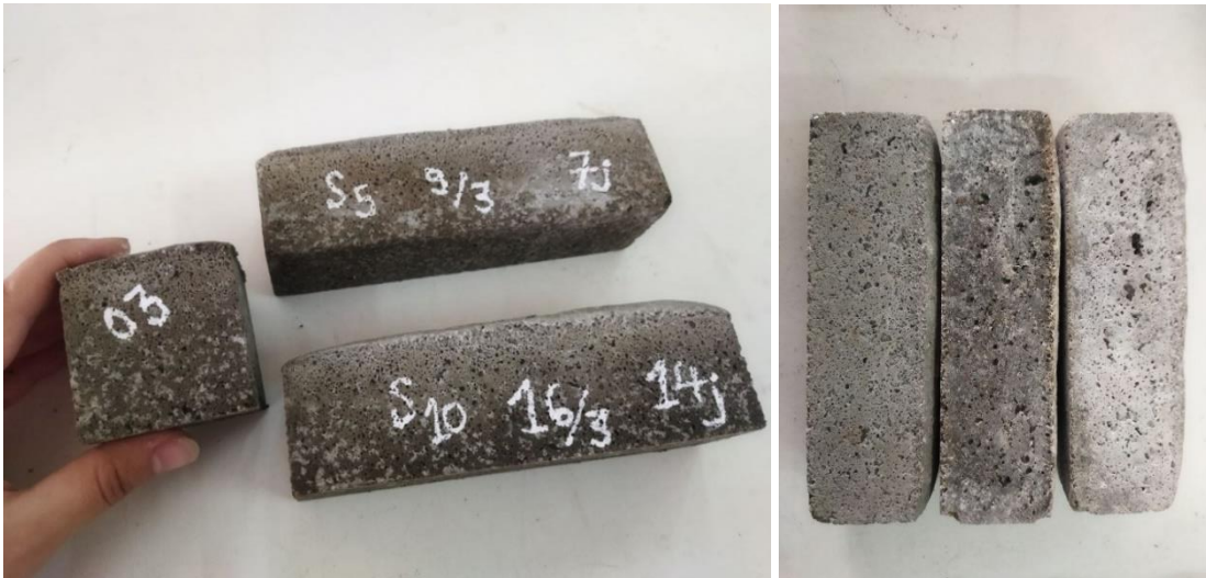
Figure III.2 : Le gonflement observé sur les échantillons
