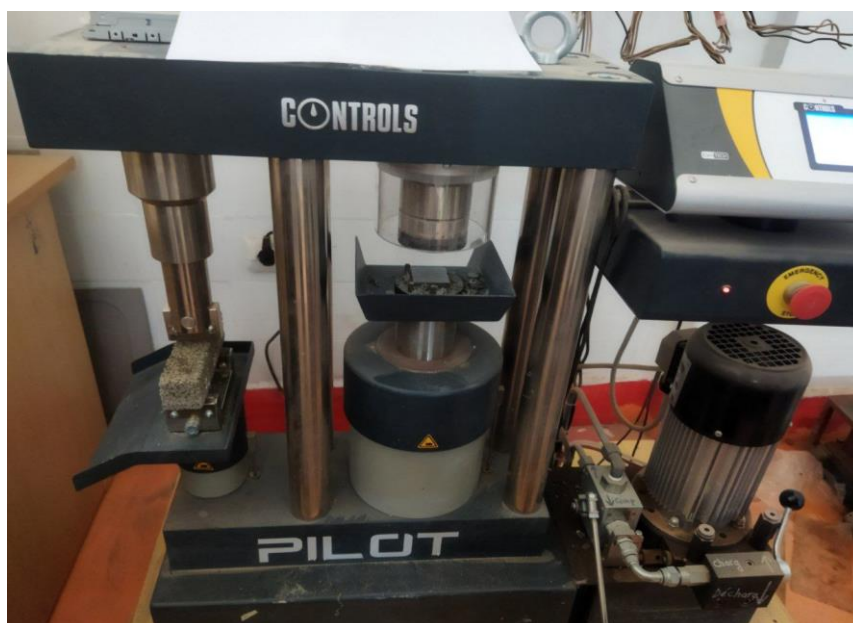
Figure II.25 : Essai de compression et flexion sur les éprouvettes
