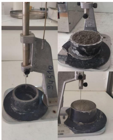
Figure II.19 : Essai de détermination du temps de prise du mortier
