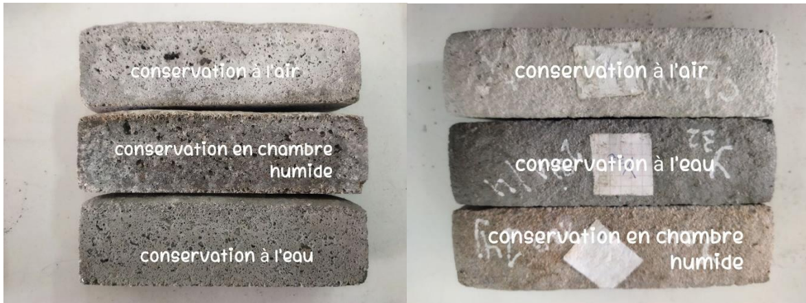
Figure III.12 : Influence du milieu de conservation sur l'aspect visuel des échantillons de mortier
