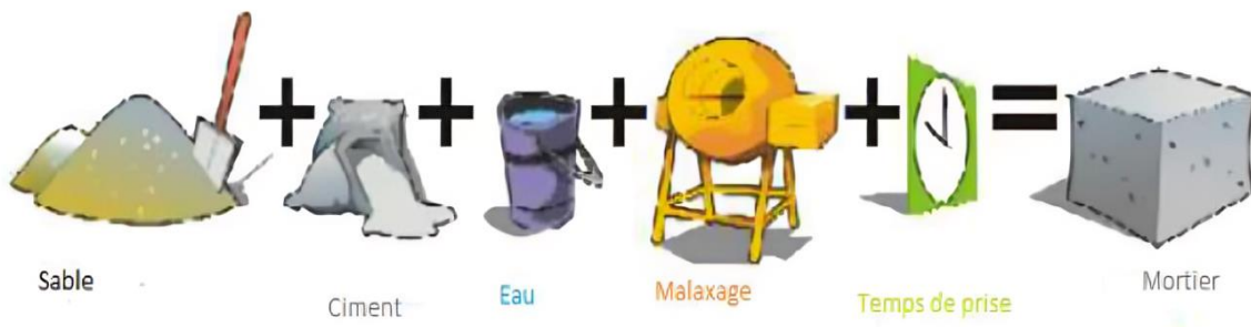
Figure I-1 : Confection d'un mortier [4]
