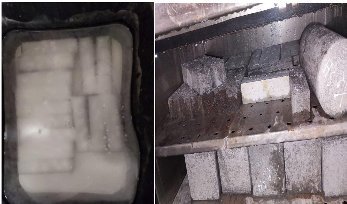
Figure II.18: Conservation des éprouvettes de mortier en chambre humide et dans l'eau
