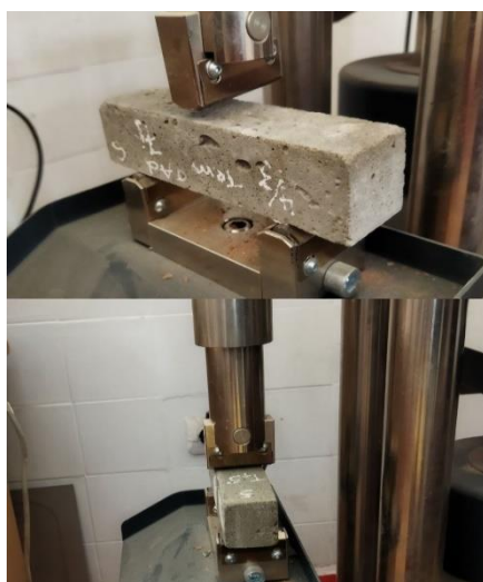
Figure II.24 : Essai de flexion sur éprouvette 4x4x16 cm 3
