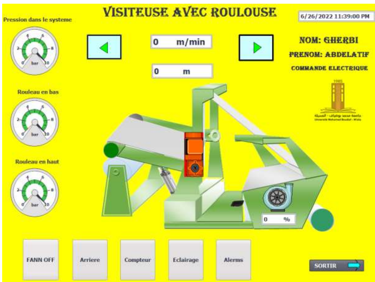
Figure IV.13 : Supervision par WINCC Runtime
