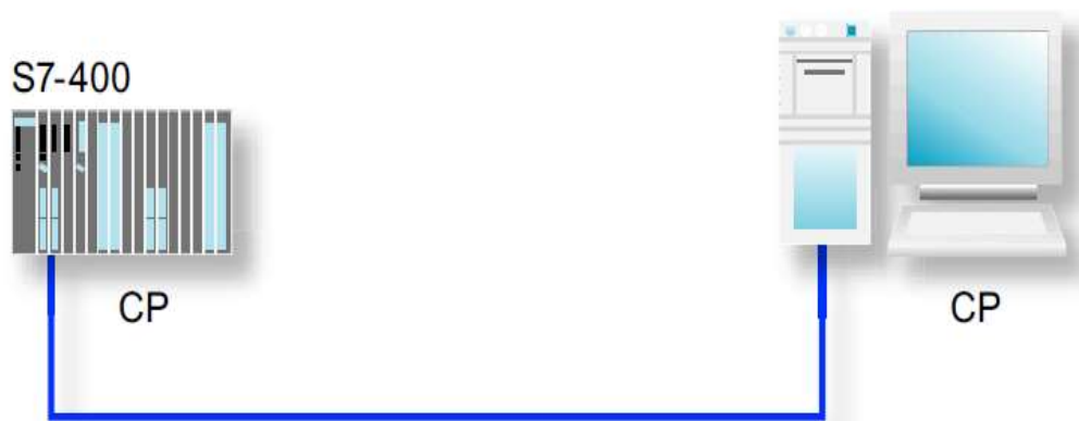
Figure II.23 : Couplage point à point
