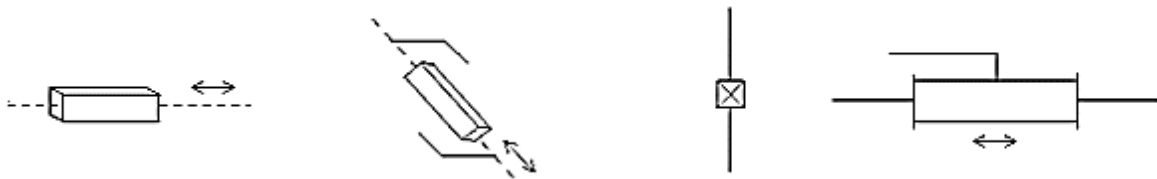
Figure 1. 14: Symbole de l'articulation prismatique [32].
