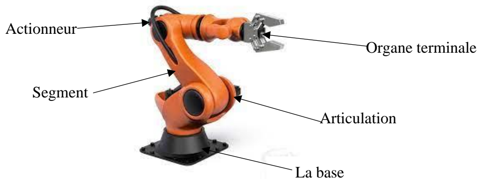
Figure 1. 12: constituants d'un robot [28].
