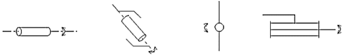
Figure 1. 13: Symbole de l'articulation rotoïde [32].
