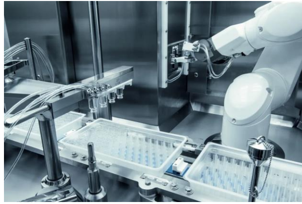
Figure 1. 5: Système d'emballage de produits pharmaceutiques ultra flexible [20].
