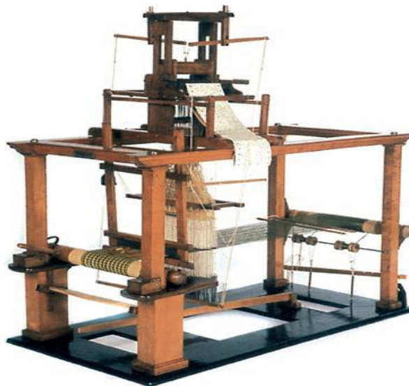
Fig. III.2. Métier à la grande tire (Jacquard P).
