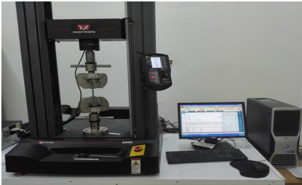
Fig. IV.14. Machine de traction /flexion. INSTRON 5969 _50 kN.
