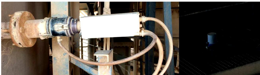
Figure V.9: Matériel de mesure (à gauche un thermocouple et à droite manomètre).
