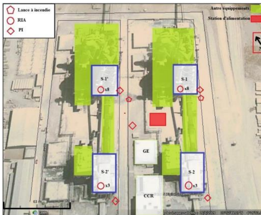
Figure V.15: Implantation des équipements du réseau anti incendie [98].
