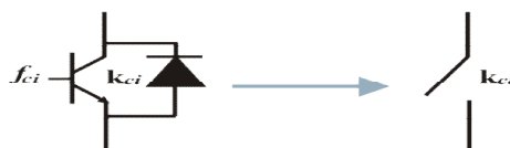
Fig.IV.8: Interrupteur bidirectionnel de paire transistor-diode
