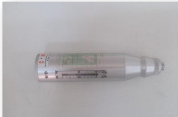
Figure II.9 : L'appareil de scléromètre
