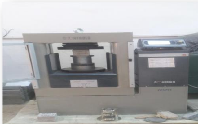
Figure II.4. Presse hydraulique capacité 3000 KN.
