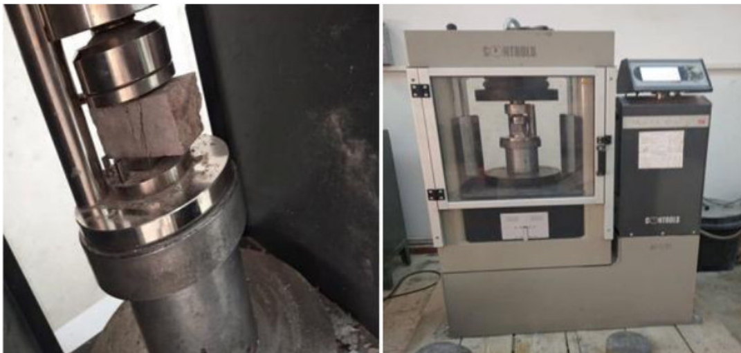
Fig. III. 18 Dispositif pour l'essai de résistance à la compression.
