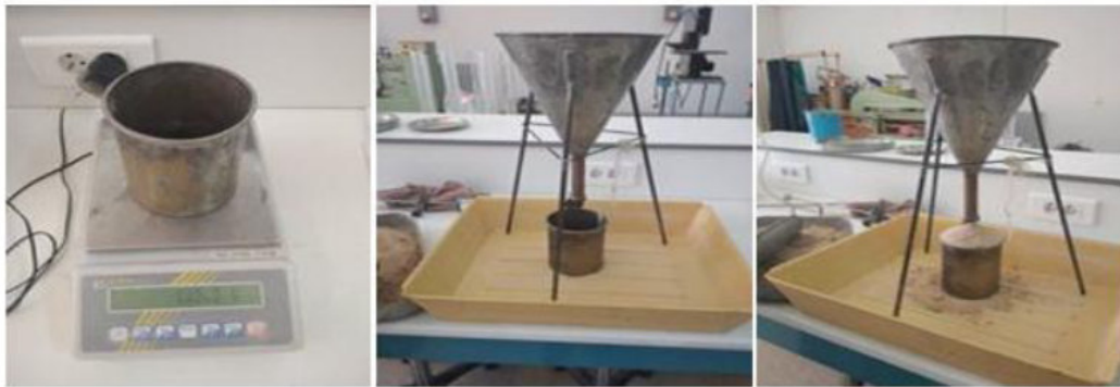
Fig. III. 2 Essai de masse volumique absolue de sable
