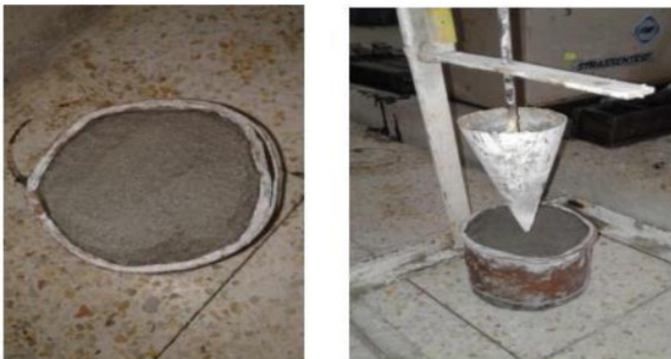
Fig. III. 15 Mesure de la fluidité du mortier.
