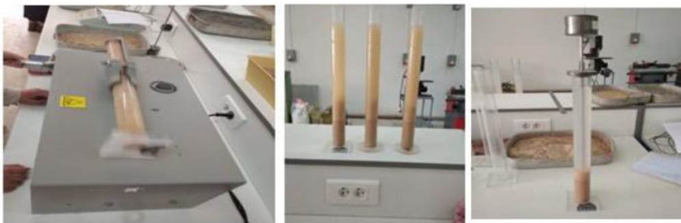
Fig. III. 7 Essai de l'équivalent de sable
