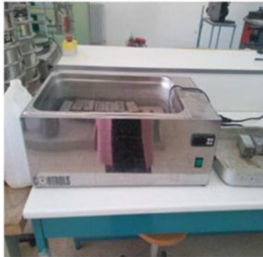
Fig. III. 22 Appareil de porosité
