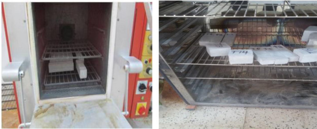
Fig. III. 14 les éprouvettes dans le four
