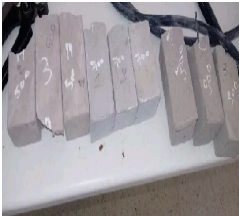
Fig. IV. 18 L'aspect des éprouvettes prismatique du mortier de fibres métalliques à la sortie du four (300 °C, 500°C et 700 °C)
