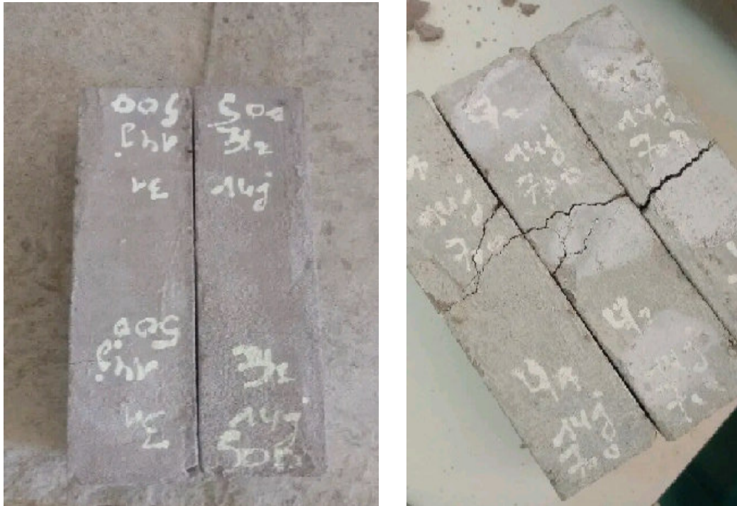
Fig. IV. 17 Échantillons de mortier exposés à haute température (500 °C et 700 °C)
