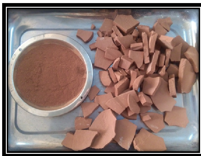
Fig. III. 9 Déchets des briques utilisés.
