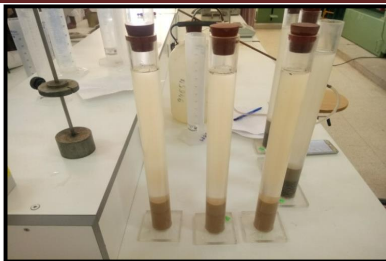
Figure III. 12 : Schéma d'essai de la masse volumique absolue de sable.
