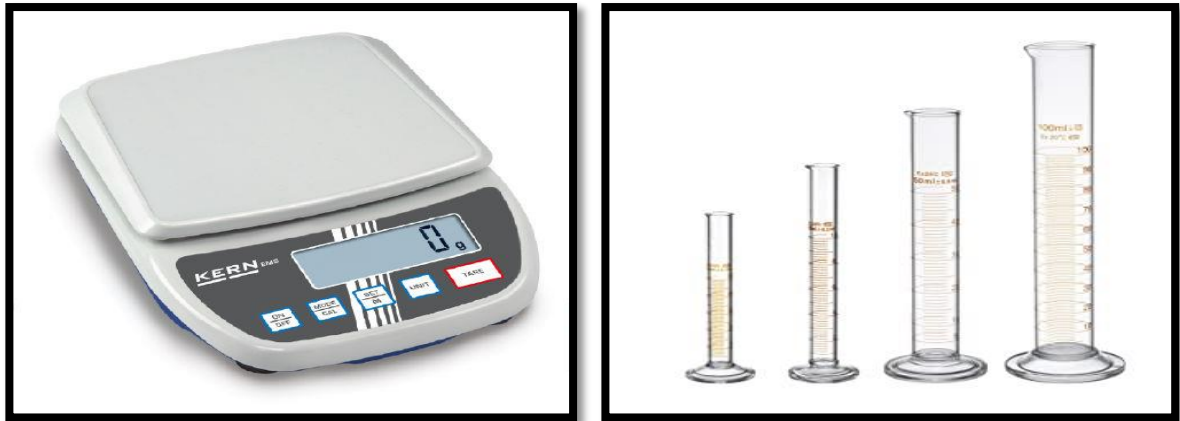
Figure III. 10 : Balance et des éprouvettes graduée pour l'essai de la masse volumique absolue.
