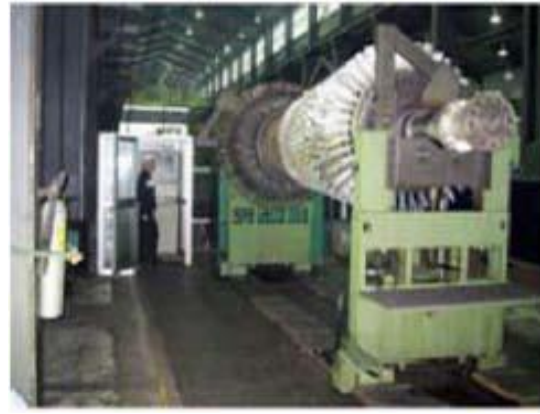
Figure. II.6 .b: Equilibrage d'un rotor turbine à gaz (pièce assemblée)
