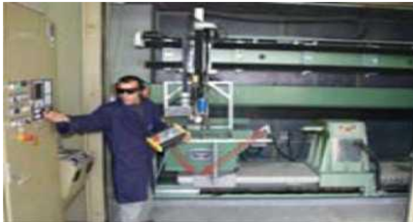
Figure. II.7: La métallisation au plasma
