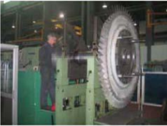
Figure. II.6 .a: Equilibrage d'une route turbine à gaz (pièce seule)
