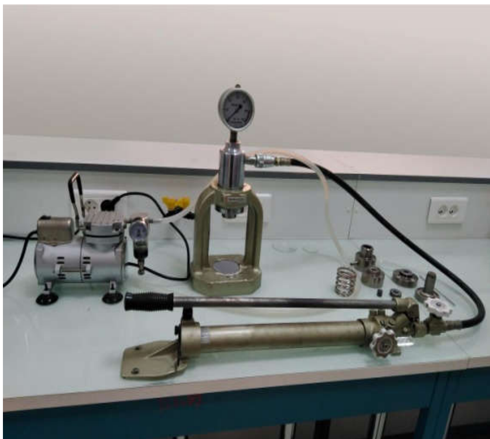
Figure II.5 : Presse pour préparation de pastille KBr.
