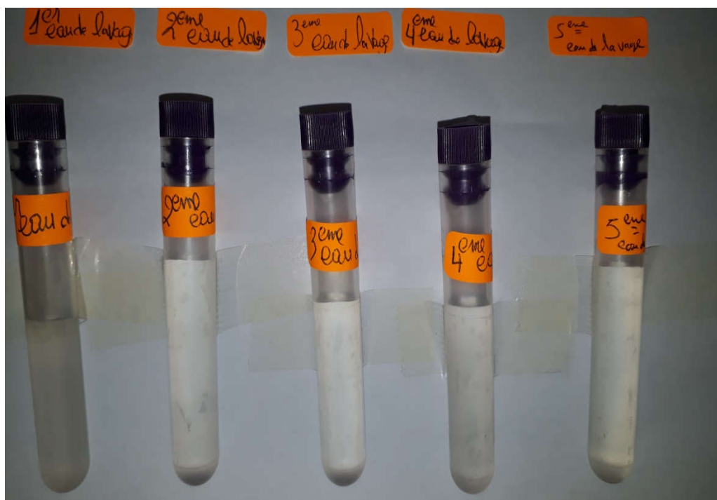
Figure.II.2. Confirmation d'absence de chlore par plusieurs lavages
