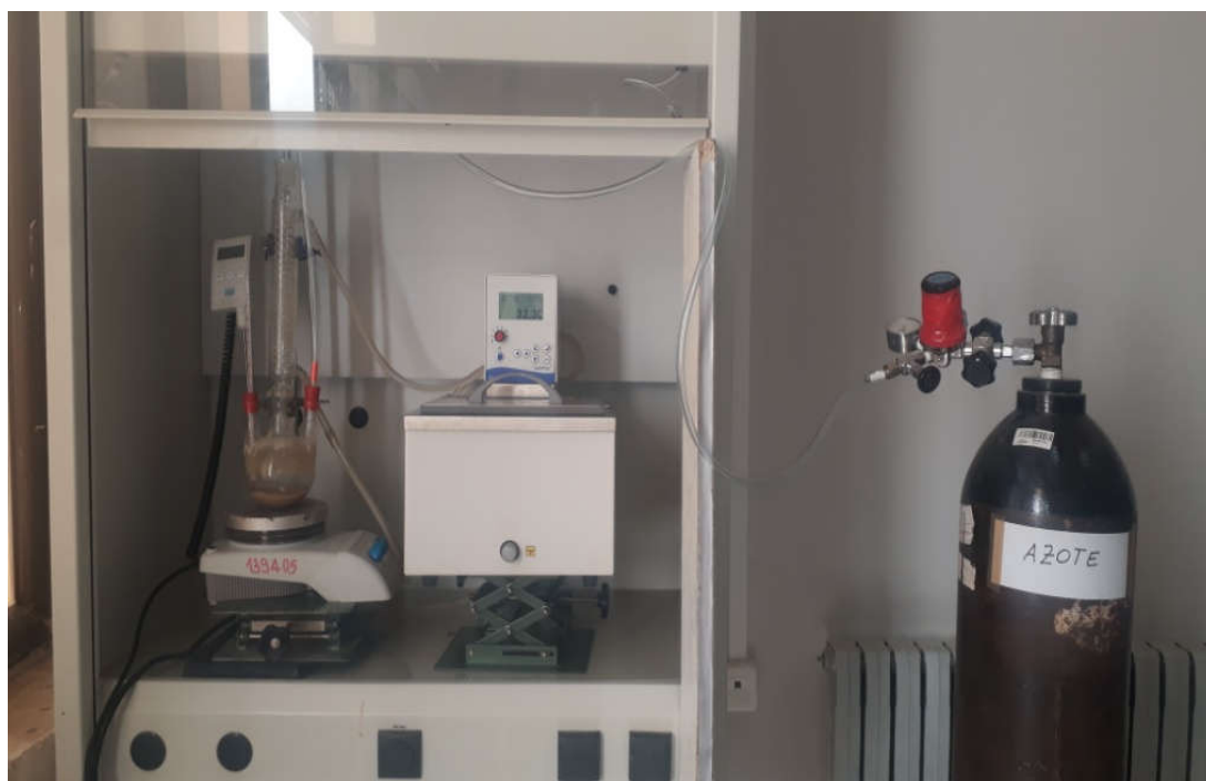
Figure.II.3 : Montage de la manipulation de greffage du TESPSH sur la Mte-Na.
