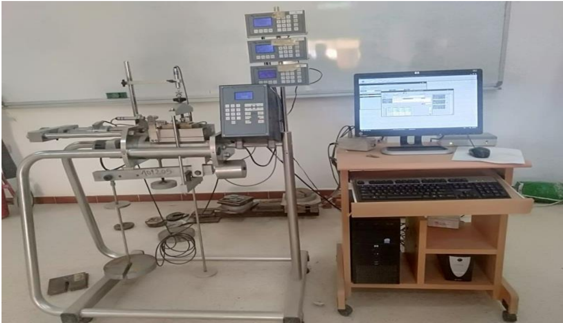
Figure II-9: Appareille de cisaillement direct
