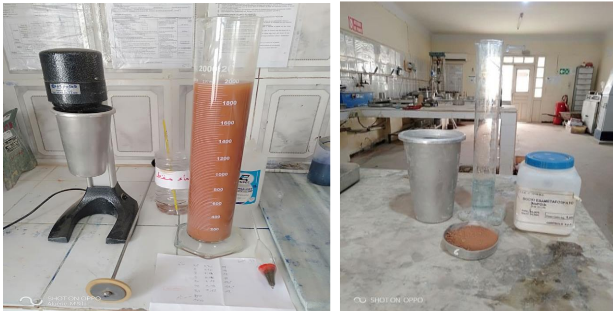
Figure II-3: L'essai de sédimentométrie.
