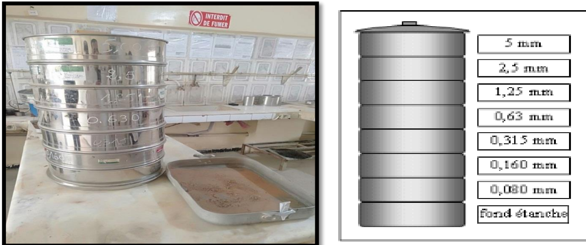
Figure II-2: Appareillage d'analyse granulométrique (tamisage).
