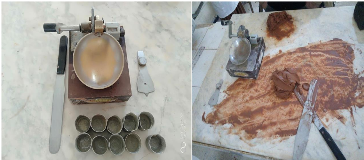
Figure II-4: Appareillage de limites d'Atterberg.
