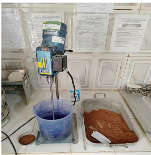
Figure II-7: Appareillage de l'essai au bleu de méthylène.
