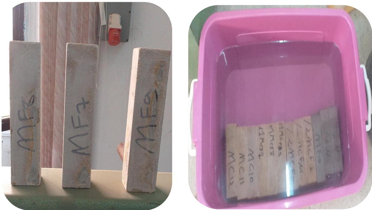
Figure (IV.16) : Echantillons de différents mortiers, après 7 jours d'immersion dans le milieu acide
