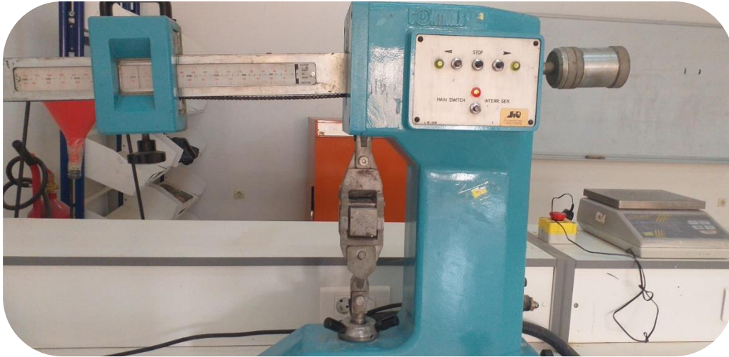
Figure. III.23: L'appareil de résistance à la flexion
