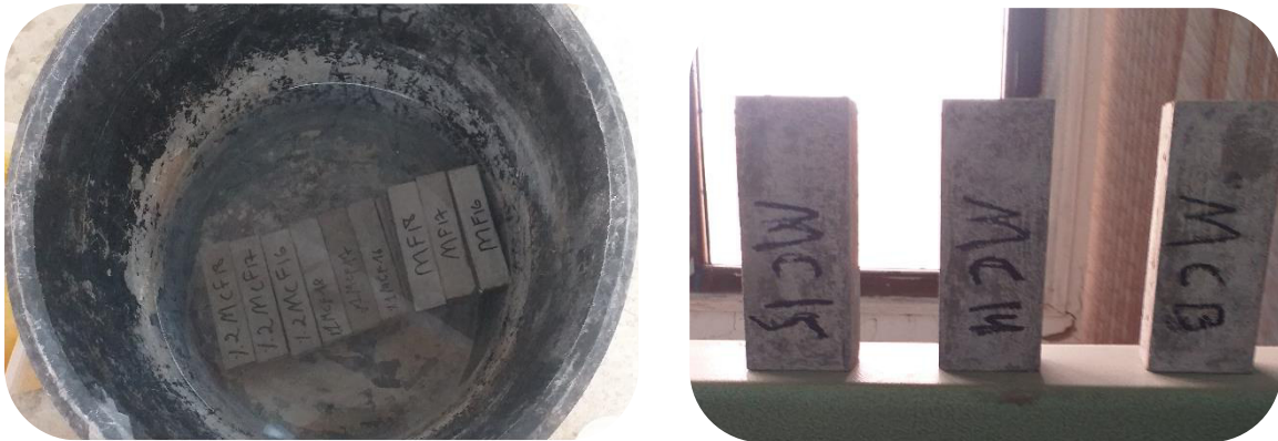
Figure (IV.24) : Echantillons de différents mortiers, après 7 jours d'immersion dans le milieu Na cl.
