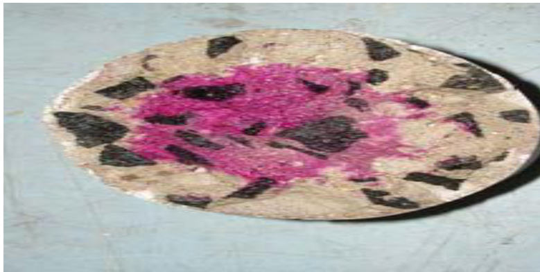
Figure.II.7 : Détermination de la profondeur de carbonatation.
