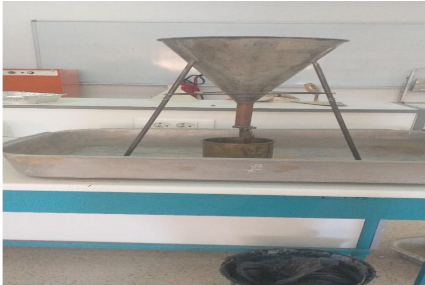
Figure. III.4: Essai de détermination de la masse volumique apparente
