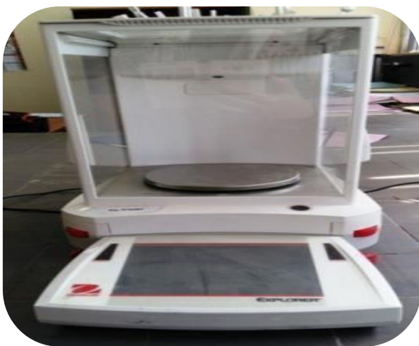
Figure. III.28: Balance de précision 0.1g (Laboratoire des matériaux -Université de M'sila)
