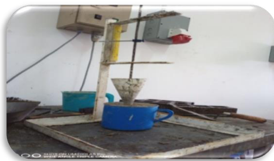
Figure. III.20: Cône d'Abram du mortier (Laboratoire de génie civil M'sila).
