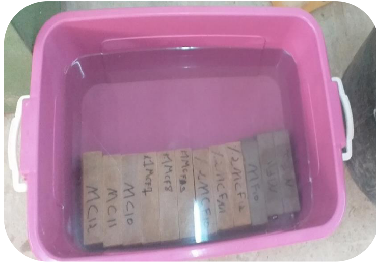
Figure. III.27: Eprouvettes immergées dans la solution acide
