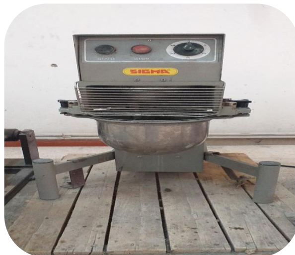
Figure. III.17: Malaxeur du mortier (Laboratoire de génie civil M'sila)
