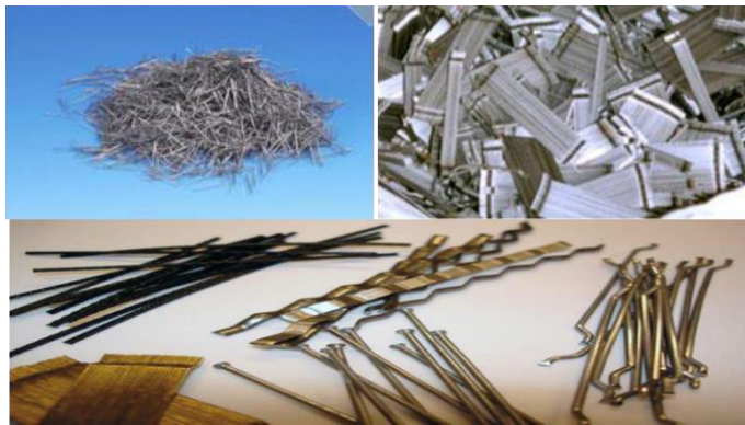
Figure.I.9 : Différentes forme de fibres métallique
