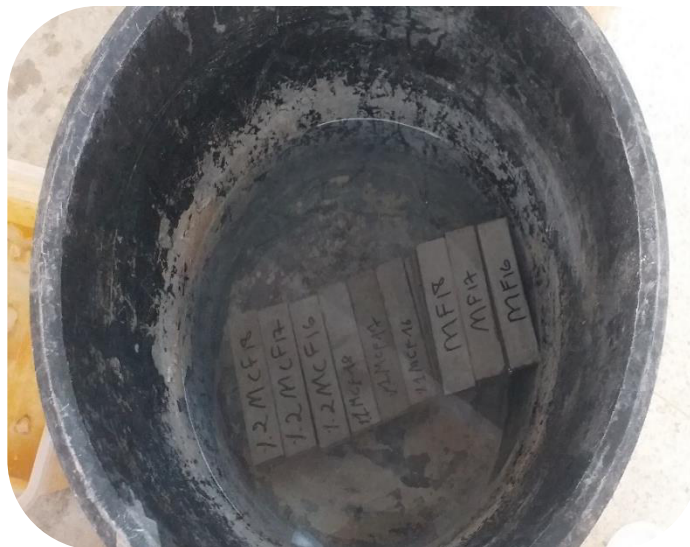
Figure. III.26: Immersion totale des échantillons dans une solution de 5% NaCl.
